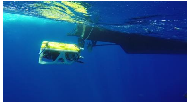
Se emplean vehículos operados por control remoto (ROV) para evaluar el estado de las áreas bénticas analizadas durante los estudios de campo en los tres países implicados.
